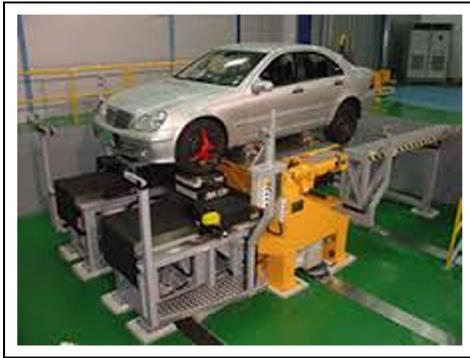
Figure 7. Suspension parameter test machine.<sup>11</sup>
