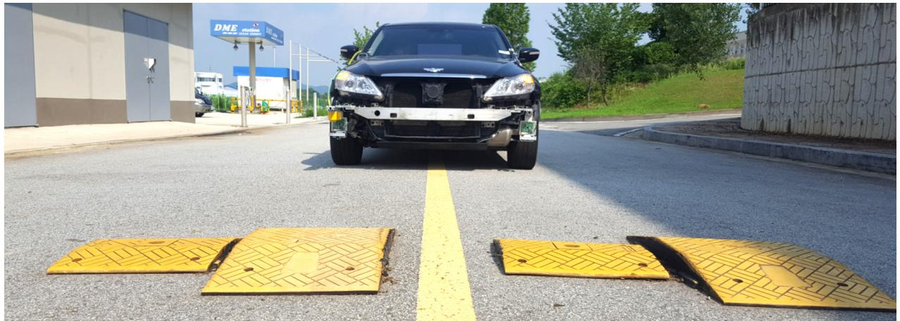
Fig. 1 예견 센서 모듈의 실차 검증을 위한 실험 환경
