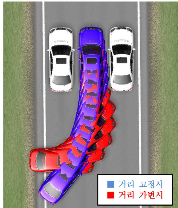
그림 5. 선회 가능한 횡방향 거리를 고정 또는 가변했을 경우의 차량 경로
